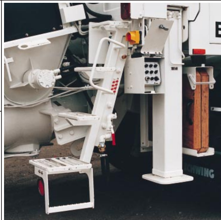
C Centrální umístěný ventilový blok pro oba zpětné (brzděné) ventily zredukovalo celkový počet použitého potrubí, hadic a šroubení v celé hydraulické soustavě.
