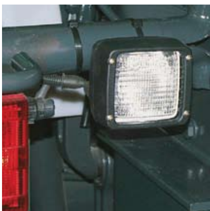
Halogenový světlomet. Je umístěn na zadní části vozidla a slouží k osvětlení prostoru výsypu na zádi stroje.
