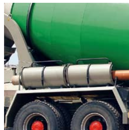
Potrubí pro tekutý beton s držákem. Slouží k ukládání tekutého betonu. Dodává se v délkách 3 a 5 m. Při použití vlastního potrubí na tekutý beton dodáváme držáky přizpůsobené výše uvedeným délkám.
