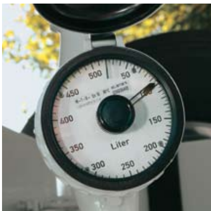
Vodoměr. Slouží k přesnému dávkování vody v rozsahu 500, případně 1000 litrů.
