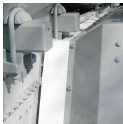
Rozšíření blatníků. Slouží k zamezení silného znečištění autodomývače při jízdách na staveništi a silnici. Doporučuje se v kombinaci s krytem rámu nástavby.
