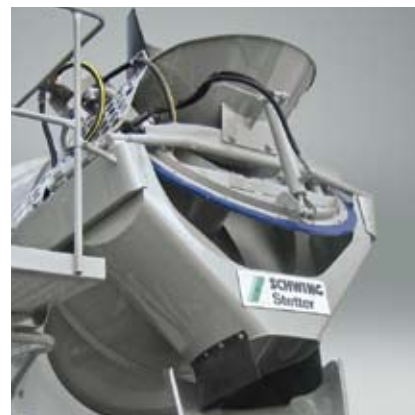
¾ uzavěr bubnu. Zabraňuje unikání kapalných médií při rozjíždění, brzdění nebo při jízdě do svahu.
