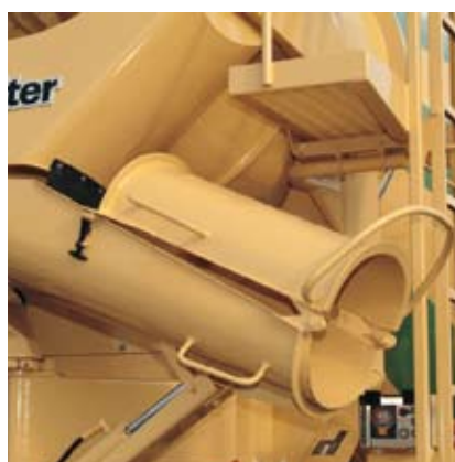
Sklopný díl. Sklopný díl vybavený madlem k bezpečnému sklopení.
