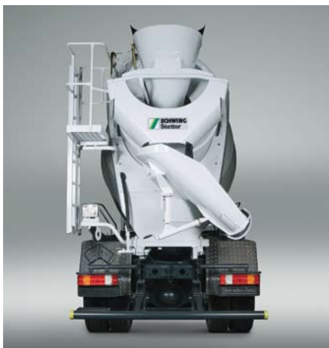
Jednoduché vypouštění do násypky čerpadla betonu dovoluje 1.450 mm dlouhý otočný žlab.
