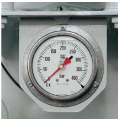
Konzistoměr. Manometr ukazující tlak v hydraulickém systému. Při stejném objemu betonu udává směrnou hodnotu změny jeho konzistence.
