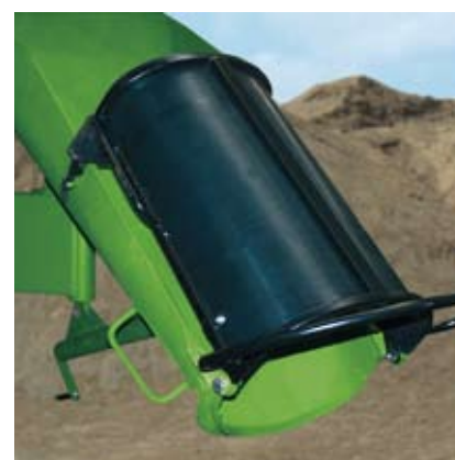
Sklopný díl z plastu. Sklopný díl vybavený madlem k bezpečnému sklopení. Díky malé hmotnosti se usnadňuje prodloužení žlabu. Možnost zavěšení dalších dvou dodatečných plastových prodlužovacích žlabů.
