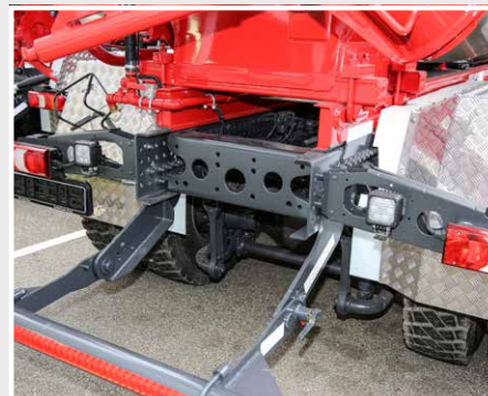
LED-Zusatzscheinwerfer am Heck (2 Stück)
