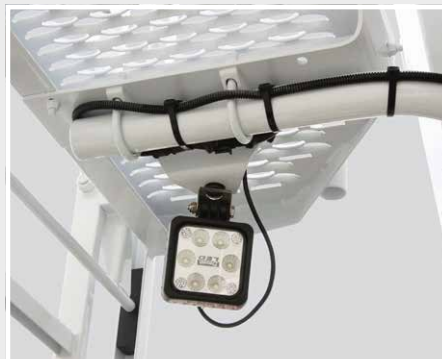
LED-Arbeitscheinwerfer unterhalb des Leiterstandpodestes
