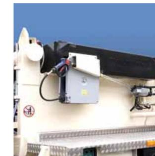
Der 600 l große Wassertank ist in unmittelbarer Nähe des Trichters angeordnet und kann optional mit einem Hochdruckreiniger sowie einer Frostschutz-Heizspirale aufgerüstet werden.
