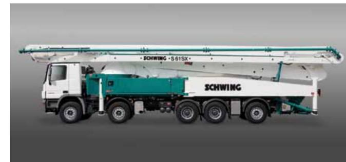
Das mit 48 t vergleichsweise geringe Gewicht lässt die Großmastpumpen flexibler, schneller und mit mehr Gewichtsreserven unterwegs sein. Die 5-achsigen Fahrgestelle zeichnen sich durch hohe Wendigkeit, sowohl auf der Straße als auch auf der Baustelle aus.
