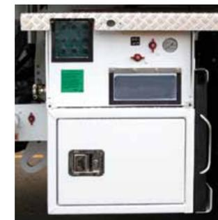
Die „Schaltzentrale am Boden“ beinhaltet neben dem Nahbedienungs-Panel mit Pneumatikregelung und Kammerschieber-Bedienung einen „Briefkasten“ für Lieferscheine.
