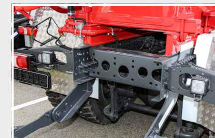
LED-Zusatzscheinwerfer am Heck (2 Stück)
