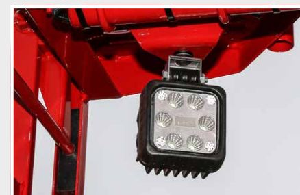
LED-Arbeitscheinwerfer unterhalb des Leiterstandpodestes
