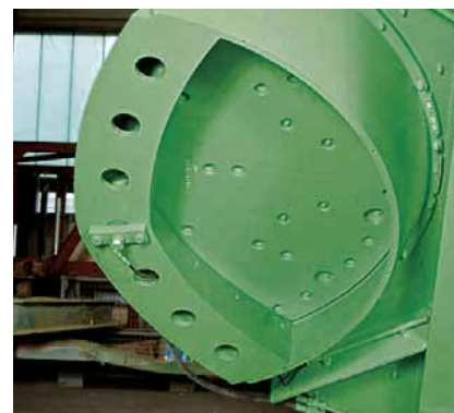
Groß dimensionierter Mischer-Verschluss mit hydraulisch betätigtem Schieber für schnelle Entleerung.
