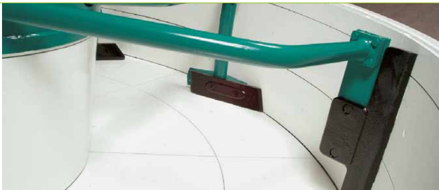
Abb. oben links und rechts: Der Innen- und Außenabstreifer unterstützt die Misch- und Austragswirkung.
