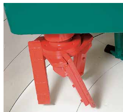
Wirbler mit aufgepanzerten Wirblerwerkzeugen sind besonders verschleißarm.
