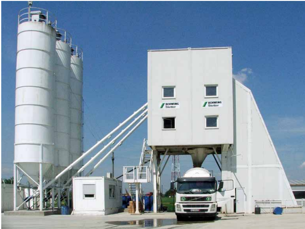
HN 2,25 mit Tellermischer, Festbetonleistung 108 m 3 /Stunde.
