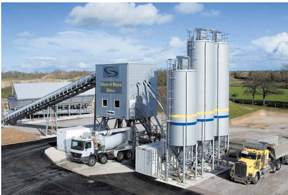
HN 1,5 mit Tellermischer, Festbetonleistung 80 m 3 /Stunde.
