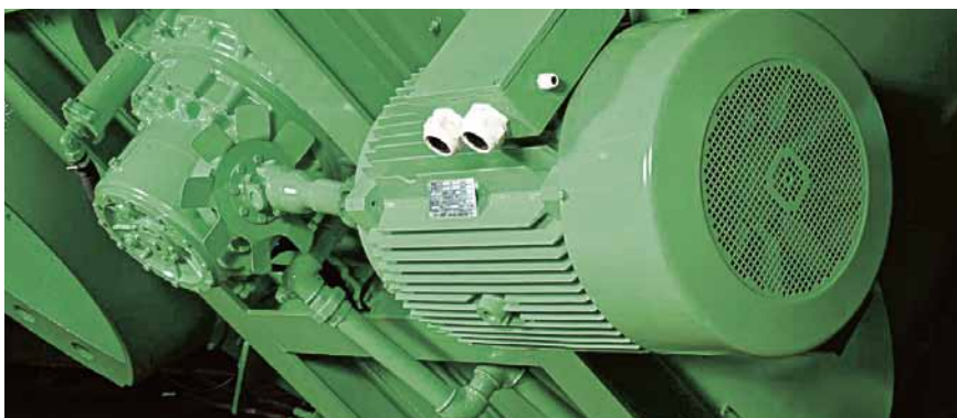
Der Antrieb mit Planetengetriebe und angeflanschter Hydraulikpumpe.
