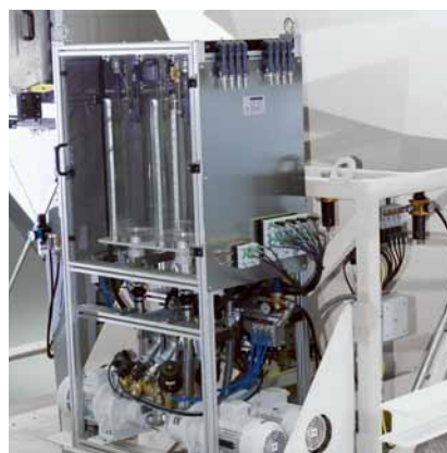
Die Additivwaage für chemische Zusatzmittel.
