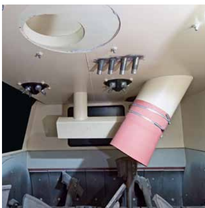
Die Düsenköpfe zur Reinigung des Mischerraumes.
