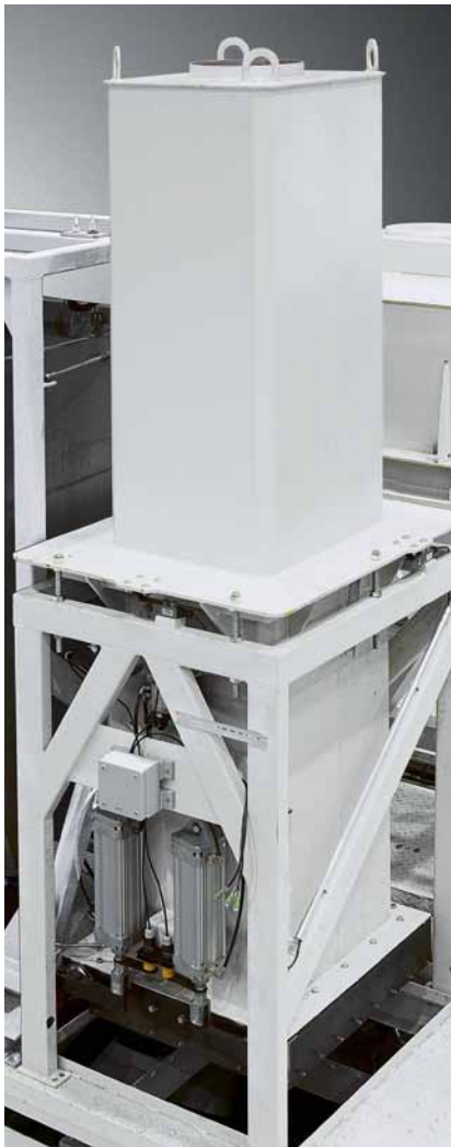
Eiswaage für die Verwiegung von Scherbenis.
