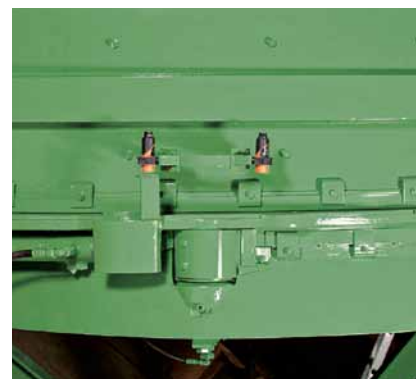
Stromausfall? Auch daran haben wir gedacht und eine hydraulische Not-Hand-Betätigung für den Mischerverschluss integriert.
