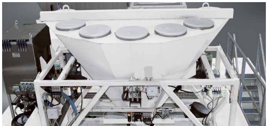
Die Bindemittelwaage für bis zu sieben Zement-Füllstoffsorten.
