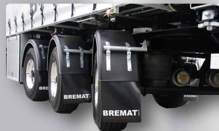
Das 3-Achs-Aufliegerfahrgestell entspricht den neuesten Sicherheits- und Qualitätsanforderungen und ist mit der europäischen Typengenehmigung versehen.
