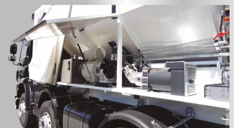
Kosten- und Platzersparnis: Anstelle einer Dieseleinheit wird die Maschine durch einen Nebenantrieb (PTO) mit dem Motor des Lkws angetrieben.
