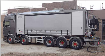
Die BreMAT F4.15 ist auf ein 4-Achs-LKW-Fahrgestell und die BreMAT F5.17 ist auf ein 5-Achs-Fahrgestell montiert.
