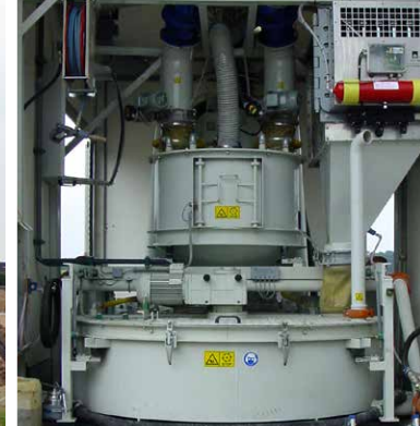
Aus Trockenstoffen wird ein Schaummörtel hergestellt. Der Vorrat befindet sich in internen oder externen Silos.
