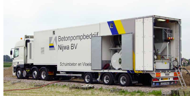
Aus Trockenstoffen wird ein Schaummörtel hergestellt. Der Vorrat befindet sich in internen oder externen Silos.
