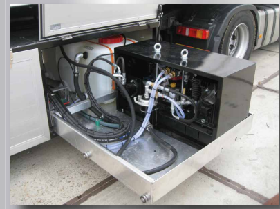
Die FE-Ausführung kann mit einem Schaumgenerator ausgerüstet werden, sodass die Anlage auch für Schaummörtelherstellung verwendet werden kann.
