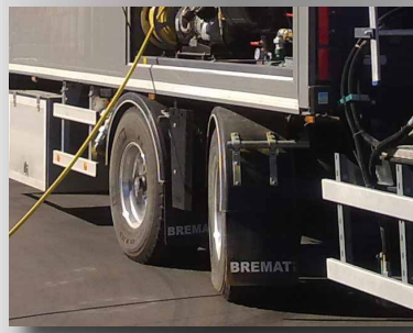
Für optimale Fahreigenschaften ist das 2-Achs-Auflieger-Fahrgestell standardmäßig mit einer stangengesteuerten Achse ausgestattet.
