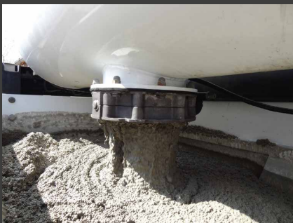
Die FE-Ausführung ist für die Herstellung und Förderung von dickflüssiger EPS-Schüttung bestimmt.
