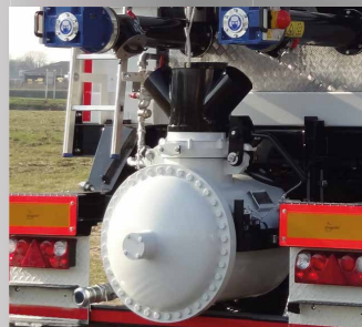
Die ZE-Ausführung ist für die Herstellung und Förderung von erdfeuchter EPS-Schüttung bestimmt.
