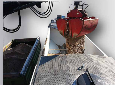
Durch das horizontale Produktionssystem kann die Anlage während des Herstellungsprozesses nachgeladen werden.
