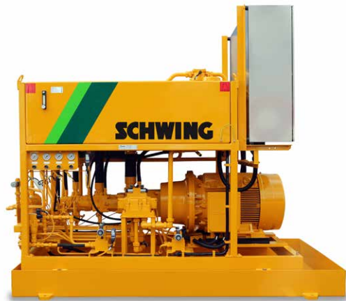
Hydraulikaggregat EHS 300 mit 30 kW Leistung und oben liegendem Hydrauliktank (bis 1000 Liter Tankvolumen)
