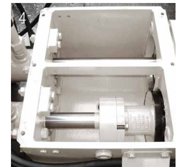
4 Förderkolben aus dem Förderzylinder herausfahren
