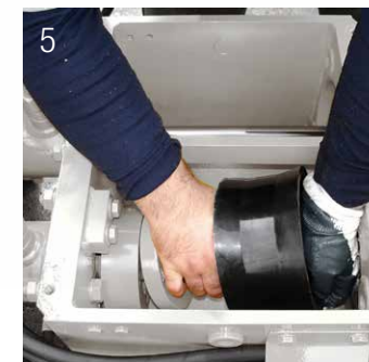
5 Alten Förderkolben entnehmen, neuen Förderkolben einsetzen
