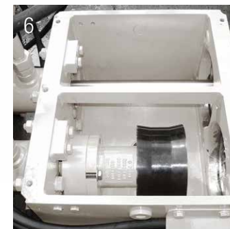
6 Förderkolben rundherum einfetten und in den Förderzylinder einfahren
