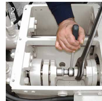
2 Verschraubung des Verbindungsstücks lösen
