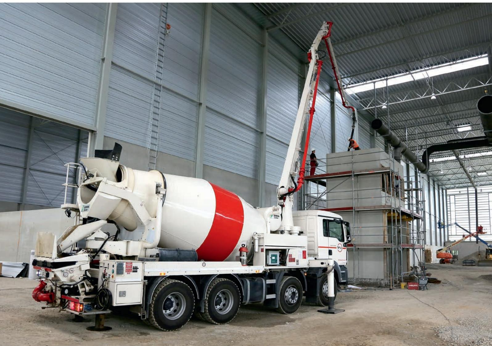
Fahrmischerbetonpumpen von SCHWING-Stetter.
