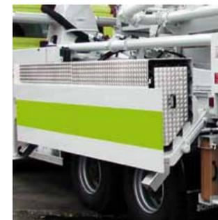
In hydraulisch absenkbaren Boxen können die Schläuche bedienerfreundlich untergebracht werden.
