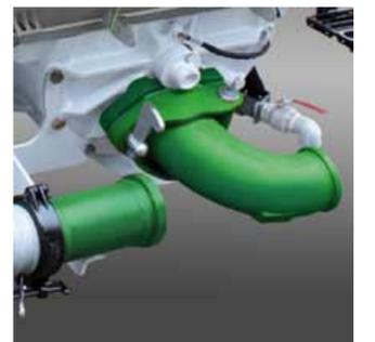
Der optional erhältliche drehbare Abgang gestattet dem Maschinisten auf jeder Seite der Maschine Förderschläuche anzuschließen.
