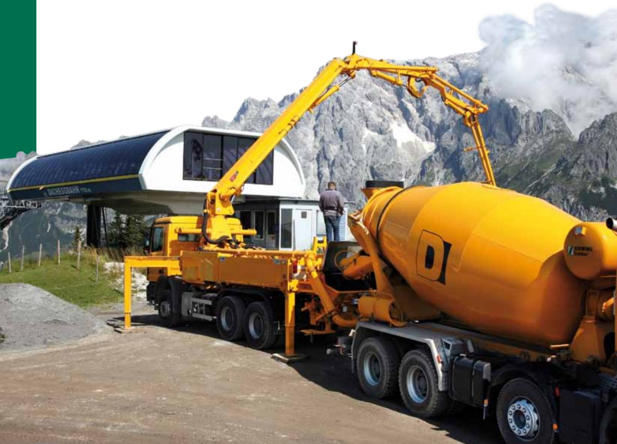
SCHWING ist dank Leichtbauweise in der Lage, ein Gesamtgewicht von unter 18 t zu realisieren, ohne dabei Kompromisse an den Kernbaugruppen Pumpenbatterie, Rock-Schieber und Verteilermast einzugehen. Auf einem 3-Achs-Fahrgestell besitzt die Maschine eine noch geringere Abstützbreite und die Möglichkeit, mehr Zubehör und Schlauchleitungen zu laden.
