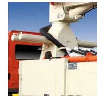
2 Schwenkzylinder auf jeder Seite des Turms sorgen für sicheren und langlebigen Betrieb des Drehwerks.
