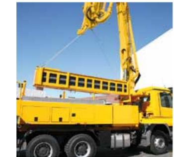
Zusätzliche Boxen für Schläuche und Rohre können mit Staplern, Baukränen und sogar dem eigenen Verteilermast dahin gebracht werden, wo das Material gebraucht wird.
