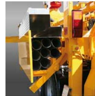
Die hydraulische Schlauchbox kann selbst bei nicht abgestützter Maschine abgesenkt werden und nimmt die Förderschläuche in bedienerfreundlicher Arbeitshöhe in Schutzhüllen auf.
