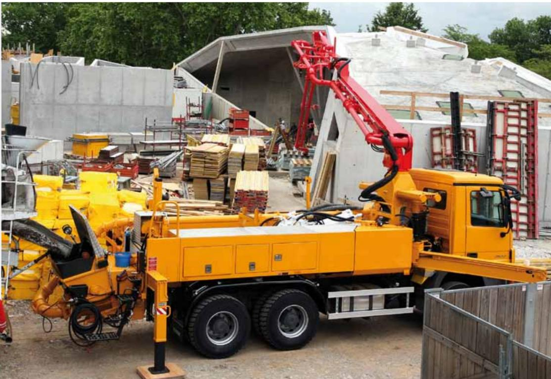
Mit abnehmbaren Schlauchboxen ausgestattet, wird dem Betreiber die Möglichkeit geboten, die Maschine als vollwertiges Saniermobil einzusetzen. Diese Boxen können sowohl durch einen Gabelstapler, als auch mit einem Kran oder dem eigenen Verteilermast auf- und abgesetzt werden.
