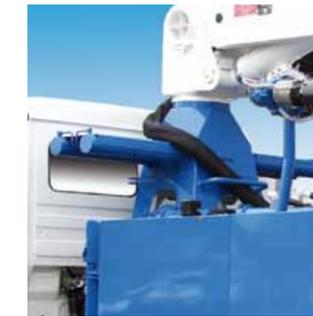
2 Schwenkzylinder auf jeder Seite des Turms sorgen für sicheren Betrieb des Drehwerks.
