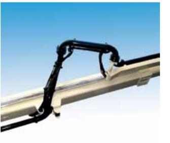
Der Verteilermast lässt sich während des Betoniervorgangs um 4,60 m teleskopieren, ohne dass sich die Strömungswiderstände des Betonflusses ändern.
