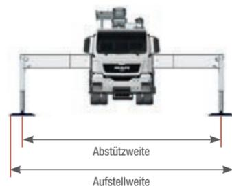
Die angegebenen Abstützweiten werden jeweils von der Mitte des Stützfußes gemessen. Unterlegplatten und eventuell erforderliche Kanthölzer müssen bei der Ermittlung der benötigten Aufstellweite entsprechend berücksichtigt werden.
