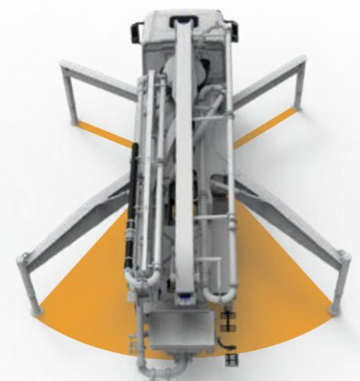
Betonpumpe mit kombinierter X- und Schwenk-Abstützung
