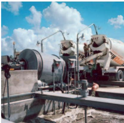
Über die Vibrationsrinne gelangt Mischkies mit einer Körnung größer 0,2 mm aus der Waschtrommel. Ein Siebeinsatz sorgt für zusätzliche Entwässerung des Mischkieses. Außerdem ist eine thermostatgesteuerte Heizeinrichtung für die Vibrationsrinne lieferbar.
