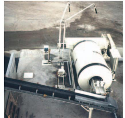
*Ausführung mit Förderband zum Abtransport der Feststoffe.*
