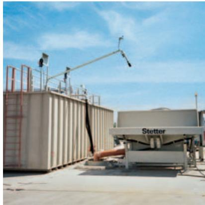
*Ausführung Überflur mit Doppelcontainer für die Zwischenspeicherung des Schlammwassers, empfehlenswert bei felsigen Untergründen oder mobiler Anwendung.*
