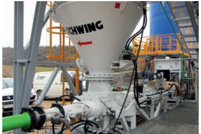
Förderung von Flugasche in einem Kraftwerk Kroatien
