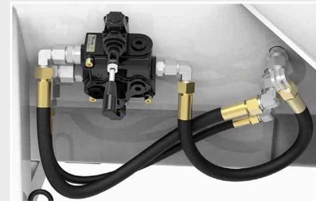
Über die hydraulische Bedieneinheit können Komponenten, wie zum Beispiel ein Absperrschieber, bequem von der SP 1800 aus bedient werden (mit bis zu 210 bar und bis zu 30 l/min.)
