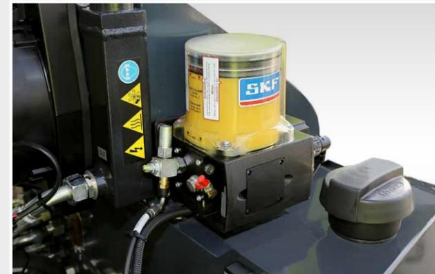
Die automatische Zentralschmieranlage versorgt zuverlässig alle angeschlossenen Schmierstellen regelmäßig mit der erforderlichen Schmierfettmenge.
