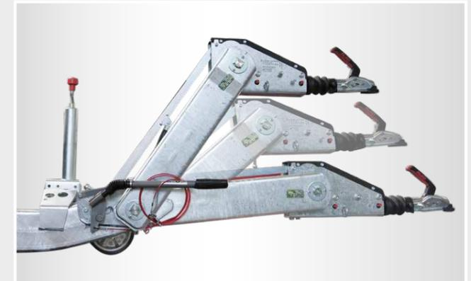
Die höhenverstellbare Zugeinrichtung erlaubt die Anpassung der Höhe des Kupplungskopfs an die Höhe der Anhängerkupplung des Zugfahrzeugs von 450 bis 890 mm Höhe. Für die Kupplung stehen 9 verschiedene Varianten zur Verfügung.
