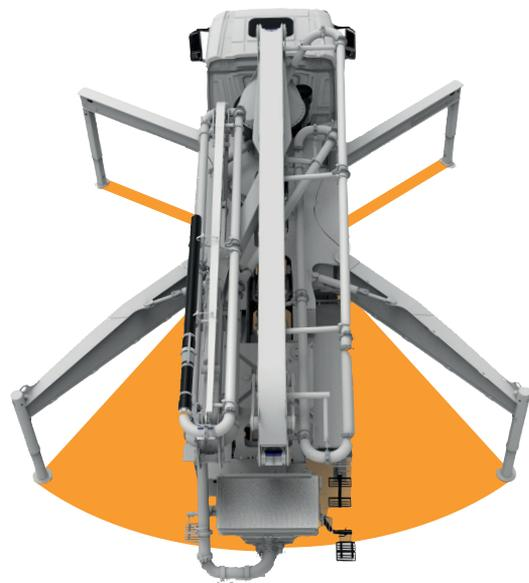
Betonpumpe mit kombinierter X- und Schwenk-Abstützung
