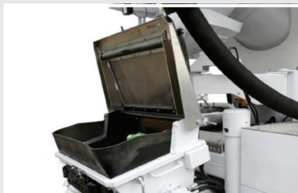
Trichterabdeckung in Stellung „Externe Befüllung“
