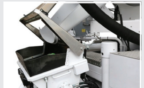
Trichterabdeckung in Stellung „Eigene + externe Befüllung“
