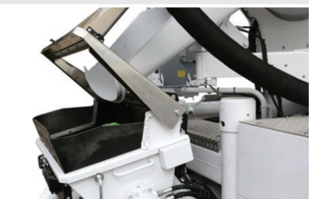
Trichterabdeckung in Stellung „Eigene Befüllung“
