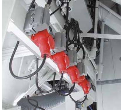
*Steckverbindungen für den elektrischen Anschluss der Peripherie vereinfachen Montage und Demontage.*
