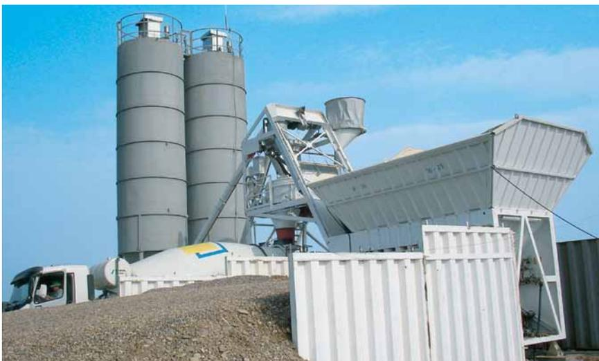
Bei größeren Vorratsmengen bzw. mehr als 4 Zuschlagsorten wird das Reihensilo verwendet. Die Verwiegung erfolgt dabei über ein Wiegeband, das die Zuschläge anschließend in den Beschicker übergibt.
