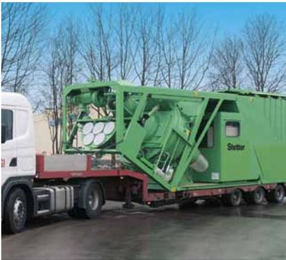
So schnell wie die Anlage versandt wird, so schnell ist sie auch wieder aufgebaut. Nach der Vermessung wird die Anlage mit dem Kran auf ein verdichtetes Planum fundamentfrei abgesetzt und ausgerichtet.
