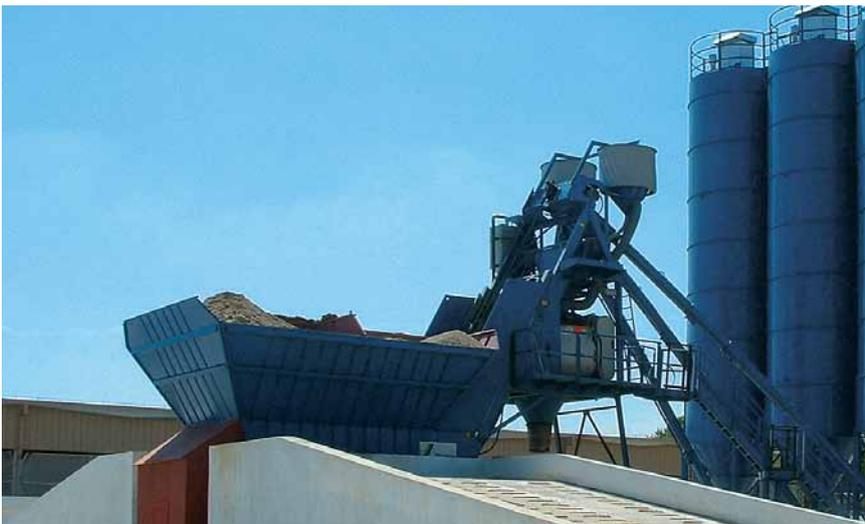
*Das Taschensilo mit 4 Boxen, das über beidseitige Rampen beschickt werden kann. Der flache Beschicker dient dabei gleichzeitig als Wiegebehälter.*
